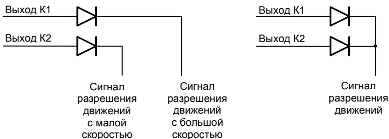
Рисунок 10 – Варианты подключения выходных реле (электронных ключей)
