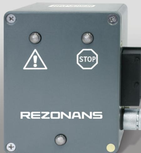
Предназначен для повышения безопасности работы подъемников (вышек) и кранов-манипуляторов. Формирует электрические сигналы их защиты от повреждения и опрокидывания при подъеме груза, превышающего номинальную грузоподъемность. Обеспечивает световую и звуковую сигнализации о перегрузке подъемника (вышки).
